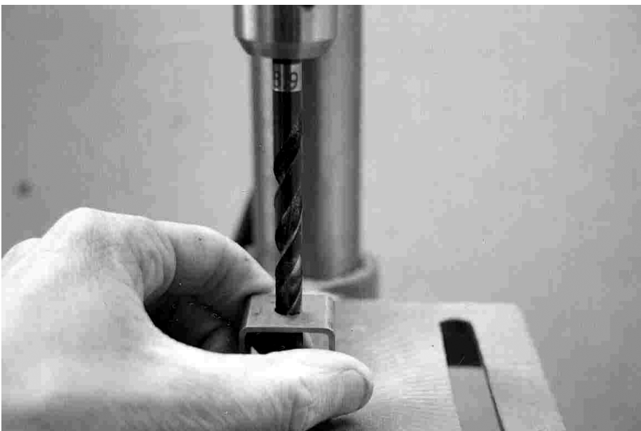
Drilling the die holes.
